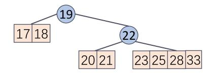
union $(T_1, T_2)$ if  $T_1 = \emptyset$  then return  $T_2$ if  $T_2 = \emptyset$  then return  $T_1$  $(L_2, k_2, R_2) = \exp(T_2)$  $(L_1, b, R_1) = \text{split}(T_1, k_2)$ In parallel:  $T_L = Union(L_1, L_2)$  $T_R = \text{Union}(R_1, R_2)$ **return** Join $(T_L, k_2, T_R)$ 15 5 3 8 9 11 2  $\left( \right)$ 20 21
