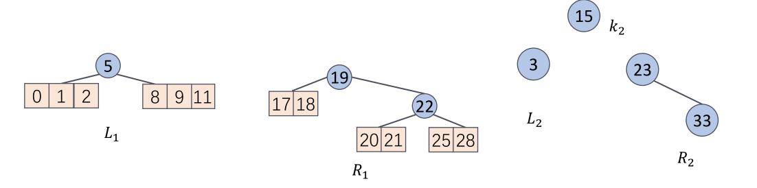
union $(T_1, T_2)$ if  $T_1 = \emptyset$  then return  $T_2$ if  $T_2 = \emptyset$  then return  $T_1$   $(L_2, k_2, R_2) = \exp (T_2)$   $(L_1, b, R_1) = \operatorname{split}(T_1, k_2)$  *In parallel:*   $T_L = \operatorname{Union}(L_1, L_2)$   $T_R = \operatorname{Union}(R_1, R_2)$ return Join $(T_L, k_2, T_R)$
